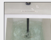
Soleumwälzung mittels Druckluft ACC96
